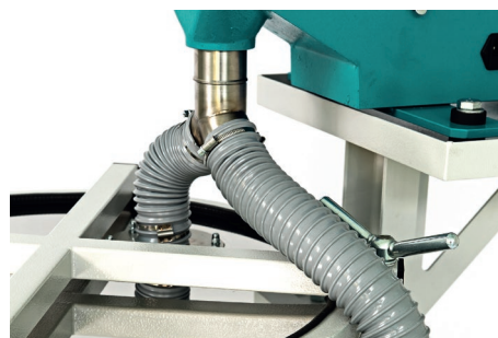
Грохот ГР 50 удвоенной производительности с одновременной загрузкой на 2 сита
