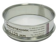
Сито C 12/38 с сеткой из нержавеющей стали
