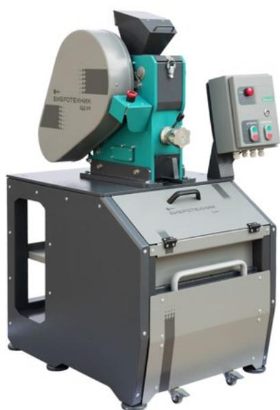
Дробильно-сократительный агрегат на базе ЦД 6М
