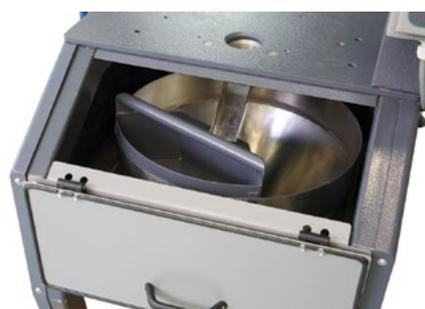
Пробоприемник с лотком на 25%
